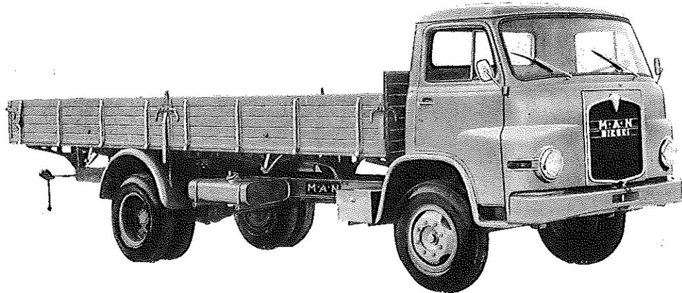
**Diesel-Motor · 6 Zylinder · 4-Takt · 120 PS bei 2700 U/min**
